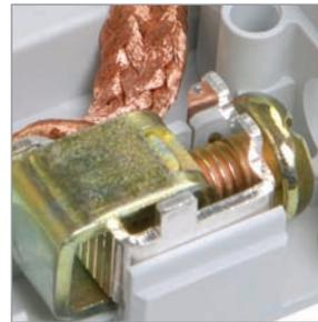
Насечки на контактных зажимах предотвращают перегрев и оплавление проводов за счет более плотного и большего по площади контакта. При этом снижается переходное сопротивление контакта и, как следствие, потери. Кроме того, увеличивается механическая устойчивость соединения.
