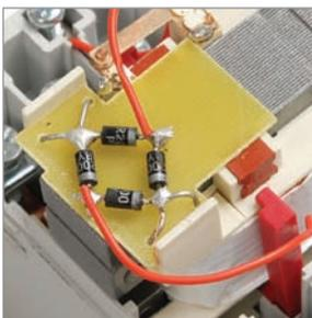
В цепи катушки управления установлен выпрямительный мост, позволяющий управлять контактором от сети переменного напряжения 220 В.
