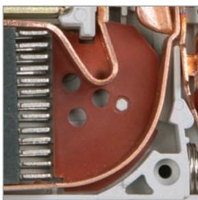
Дугоотводящая пластина подвижного контакта выполнена в виде гладкой кривой, что значительно облегчает затягивание дуги в дугогасительную камеру.
