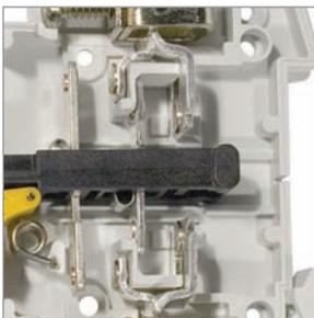
Благодаря своей конструкции (двойной разрыв цепи) позволяет практически исключить пробой и перекрытие дугой по изоляции даже при длительной эксплуатации и сильном загрязнении.
