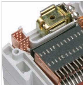
Двойная искрогасящая решетка на выходе дугогасительной камеры повышает пожаробезопасность аппарата, препятствуя выбрасыванию продуктов горения наружу.
