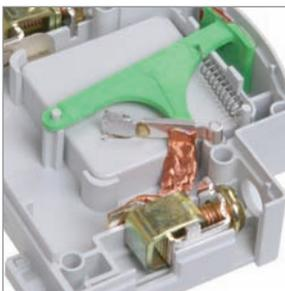
Применение поворотного механизма индикатора рабочего состояния позволяет избежать ошибок индикации.
