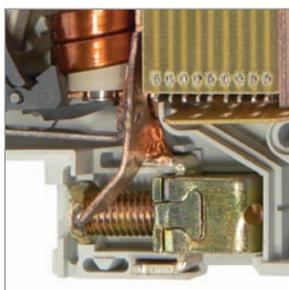
Защита механизма теплового расцепителя плексигласовой вставкой от изменения заводских настроек.
