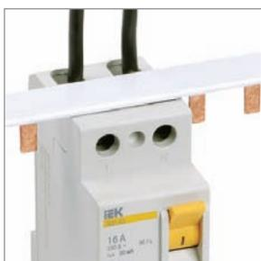
Реализована возможность двойного одновременного присоединения как шиной (PIN или FORK), так и гибким проводником сечением до  $50 \text{ мм}^2$ .
