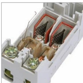
Дугогасительные решетки с увеличенным количеством пластин, расположенные в каждом полюсе, позволяют достичь более эффективного гашения электрической дуги.
