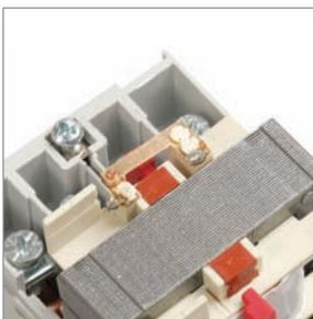
В цепи катушки управления контакторов КМ25-40, КМ40-40, КМ63-40 установлен дополнительный размыкающий контакт, позволяющий снизить ток удержания в 5 раз по сравнению с пусковым.
