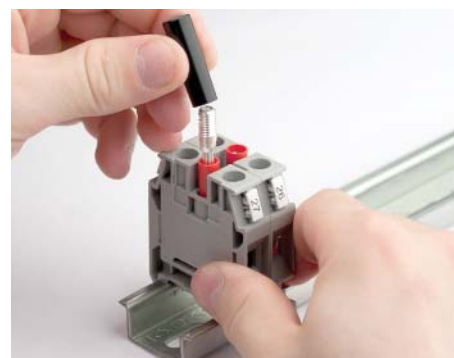
3. Закрепите прижимным винтом проводник в щупе
