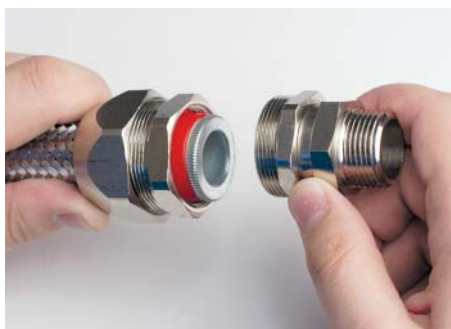
7. Соедините промежуточный корпус и корпус муфты. Надежно затяните с помощью ключей гайку, промежуточный корпус и корпус муфты для получения заявленной степени IP и надежности фиксации оплетки металлорукава
