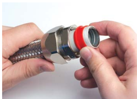
4. Наденьте зажимное уплотнительное кольцо красного цвета на металлорукав. Уплотнительное кольцо одевается стороной с утолщением под зажимную гайку
