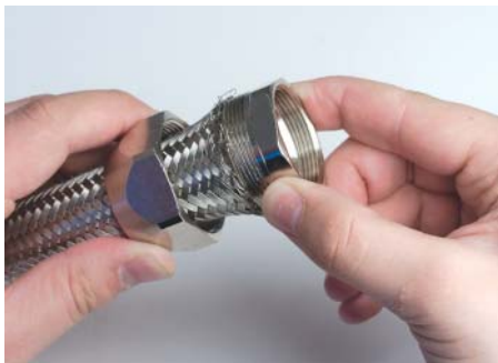
2. Установить промежуточный корпус под оплетку, предварительно удалив скотч с металлорукава. Плотнo зафиксировать гайку и промежуточный корпус между собой, тем самым закрепив оплетку металлорукава в аксессуаре
