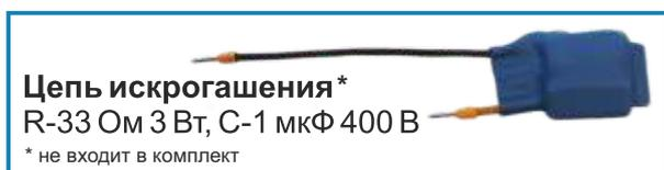
Для защиты линии от возникновения искры в однофазных и трехфазных сетях рекомендуется включать параллельно катушке пускателя искрогасящую цепочку R-33 Ом 3 Вт, С-1 мкФ 400 В.
